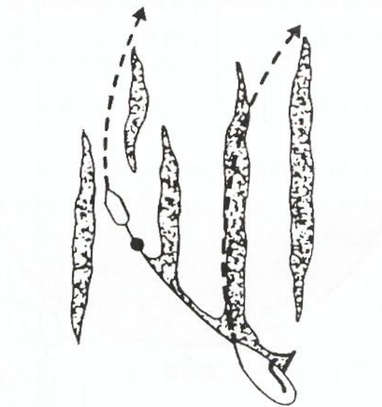
图 5-18 单船收油系统另加一船拖曳围油栏，以增加围油率
