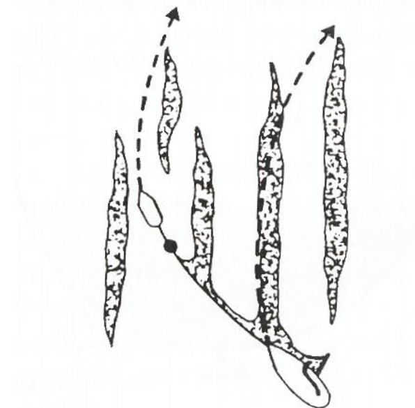
图 5-18 单船收油系统另加一船拖曳围油栏，以增加围油率
